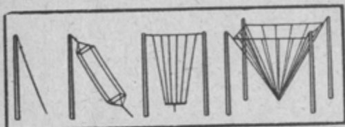
Diverse forme de antene: cu un fir; antena prismatică; antenă-perdea; antenă cu conul răsturnat.
